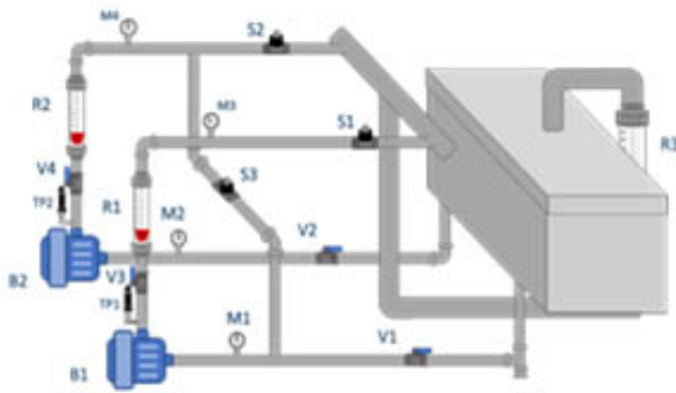
Fig. 2. Banco de pruebas con bombas centrífugas.
