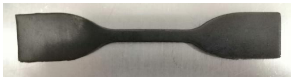
Fig. 2. Probeta de tipo corbatín del elastómero base.
