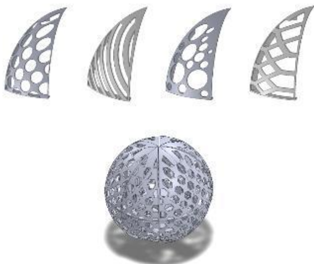
Fig. 5.2 Propuesta de mayado para la cubierta.
