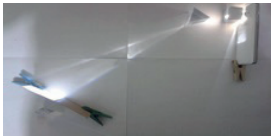
Figura 3. Disposición de la linterna, los colimadores y los prismas
