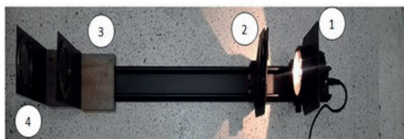
Figura 6. Disposición de la fuente (1), los polarizadores (2), (3) y el polarizador analizador (4)
