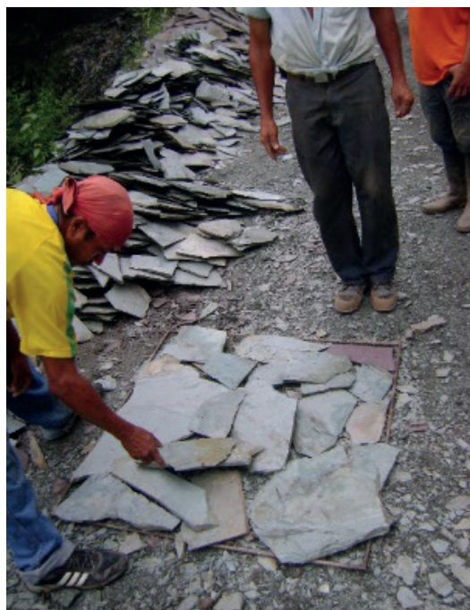
Fotografía 1. Cálculo de una tonelada de lajas de piedra-tablón por medio del metro cuadrado o lineal.
