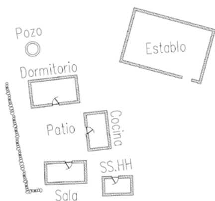
Figura 8. Distribución espacial de la arquitectura vernácula P_{04} (-15.715236, -70.199692), con construcciones de adobes y con cobertura de lámina metálica acanalada
