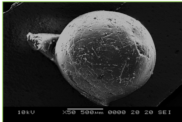
FIGURA 9. A Microfotografía de las esferas de hidrogel EDGE-PVA Q tomada con el microscopio de barrido electrónico (SEM) a 10kV
