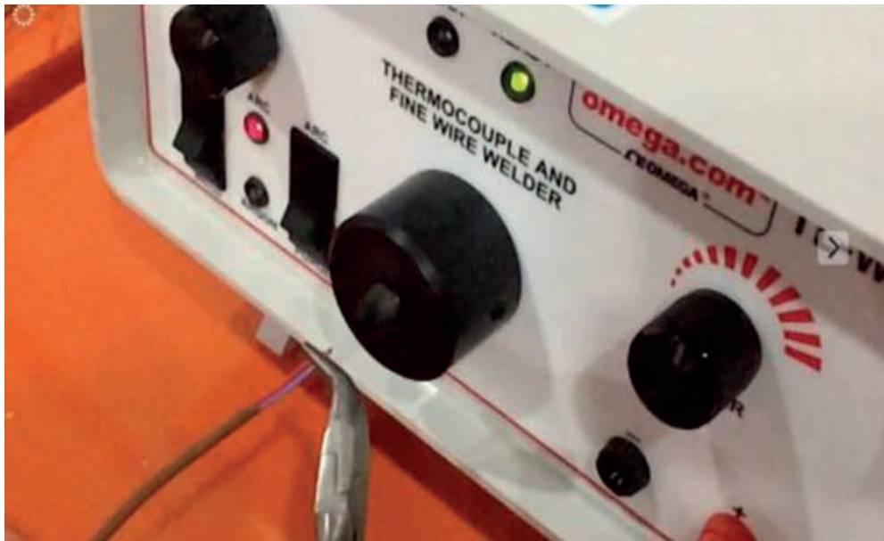
FIGURA 3. Soldando los termopares tipo “T” con equipo especializado
