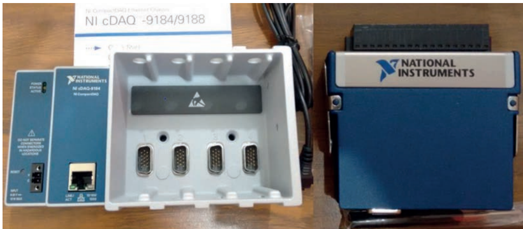
FIGURA 4. Adquisición de datos para termopares chasis cDAQ y módulos DAQ NI.
