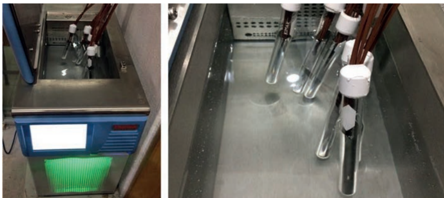
FIGURA 5. Calibración y verificación de termopares utilizando un baño térmico
