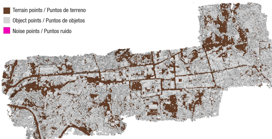
Figure 6. Discretization of point cloud into three classes: terrain, objects and noise. Figura 6. Discretización de nube de puntos en tres clases: terreno, objetos y ruido.
