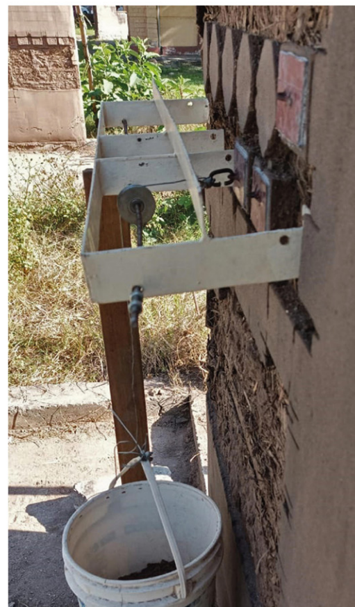
FIGURA 2 | Instrumental de arrancamiento para los muros experimentales de TAE expuestos a la intemperie. Fuente: planimetría y fotografía de elaboración propia.
