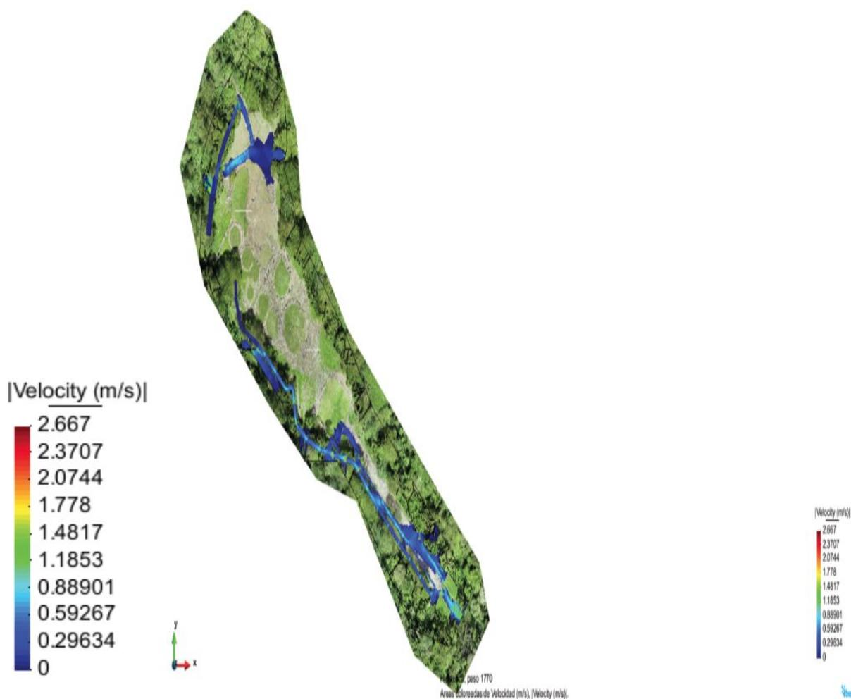
Figura 8. Velocidad con zanja de infiltración con T=50 años +18%.
