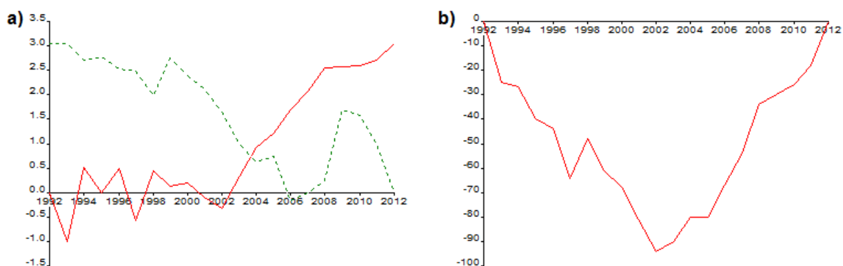
Figura 8. Velocidad máxima anual del viento para la estación meteorológica de Cabo Lucrecia en el período 1992-2012 representada por la prueba de Mann- Kendall (a) y el estadígrafo de Pettitt (b).
