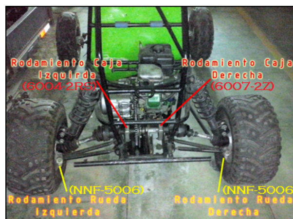
Figura 5: Ubicación de los rodamientos en el sistema de transmisión
