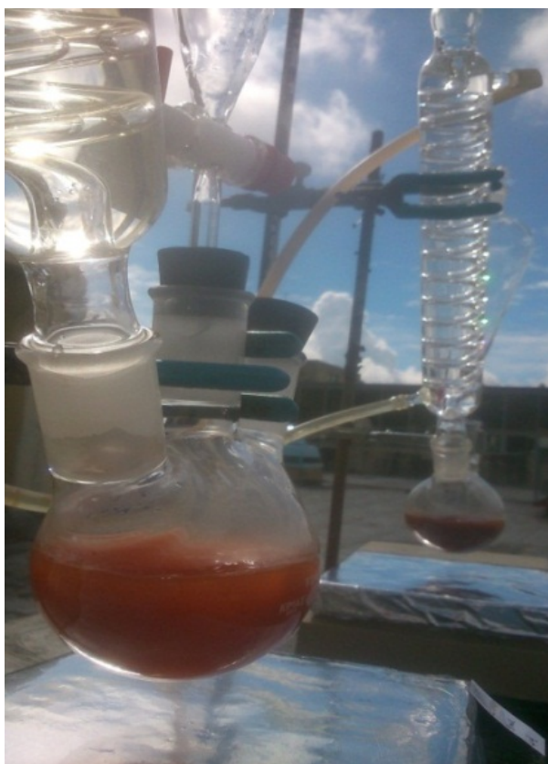
Figura 1: Montaje experimental del reactor para el proceso de oxidación avanzada
