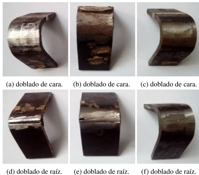
Figura 21: Probetas con 4 cordones de soldadura
