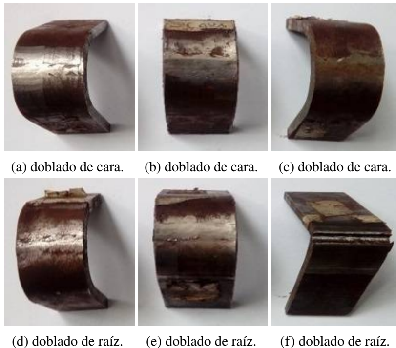
Figura 19: Probetas con 2 cordones de soldadura
