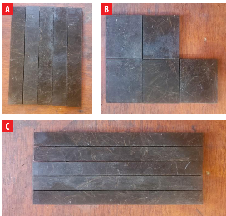
Figura 3. (a) Probetas de flexión;(b) probetas de impacto;(c) probetas de tracción.
