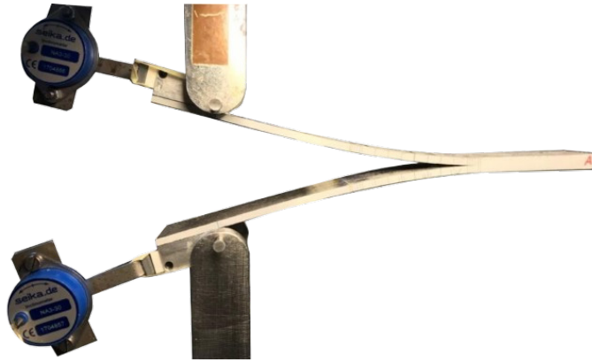
FIGURA 2. Muestra MD-DCB post-procesada e instrumentada durante ensayo.
