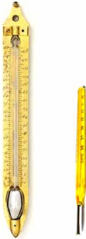
Figura 1. El termómetro de mercurio apenas experimentó cambios en 300 años. Izquierda: Termómetro original de Fahrenheit; derecha: Termómetro clínico moderno. Imagen obtenida de The Linda Hall Library of Science, Engineering & Technology. https://www.lindahall.org/daniel-fahrenheit/ [7].
