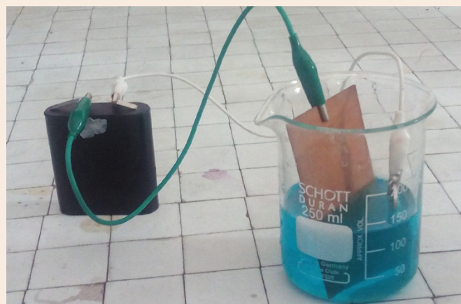
Figura 1. Representación del sistema electroquímico para las pruebas de electrodeposición.
