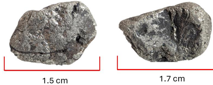
Figura 5. Pirita gruesa producto de la trituración, los tamaños rondan entre 0.2 cm hasta 1.8 cm (fotografía propia).
