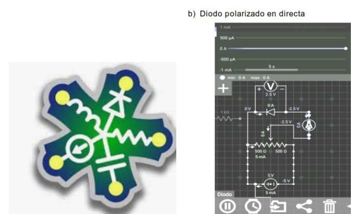
Figura 2 Representación de la interface de la aplicación móvil. Every Circuit. Característica Volt. Ampérica de un diodo.
