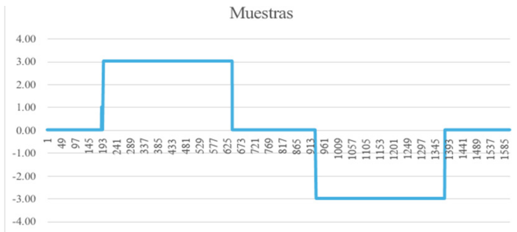
Figura 16 - Respuesta del contador que almacena la cantidad de muestras por fuera de los límites establecidos.
