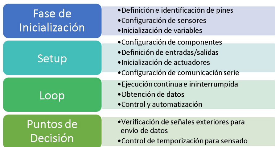
Figura 2 – Ciclo de inicialización, configuración y control del Arduino.
