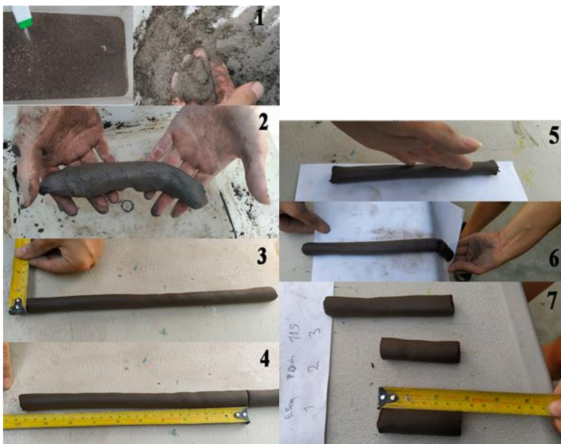
Figura 4. Proceso de prueba de churro. Fuente: Elaboración propia (2018).
