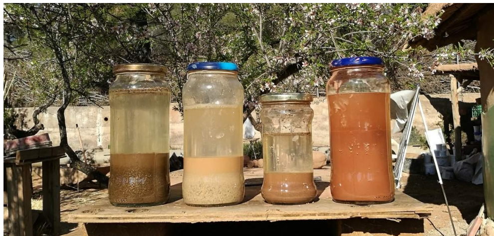
Figura 3 Prueba de botella. Fuente: https://www.arquitecturaysalud.com/bioconstruccion/principios-de-bioconstruccion (consultada el 9 de febrero de 2020)
