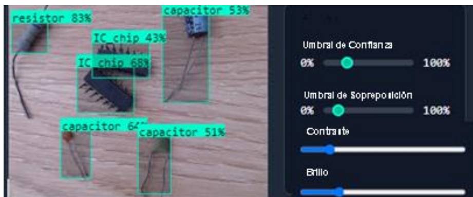
Figura 4. Imagen modelo de la interfaz mostrando la detección de componentes en el modo aprendizaje (Estudiante) de la aplicación insAltech Circuit Mentor App
