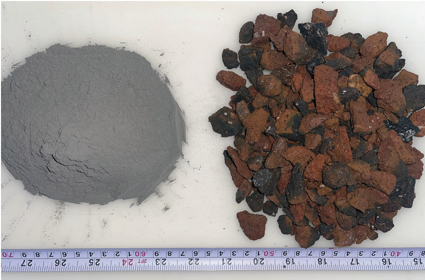
Figura 3. Agregado reciclado de arcilla termoexpandida y ceniza de bagazo de caña de azúcar. Fuente: Fotografía de los autores.
