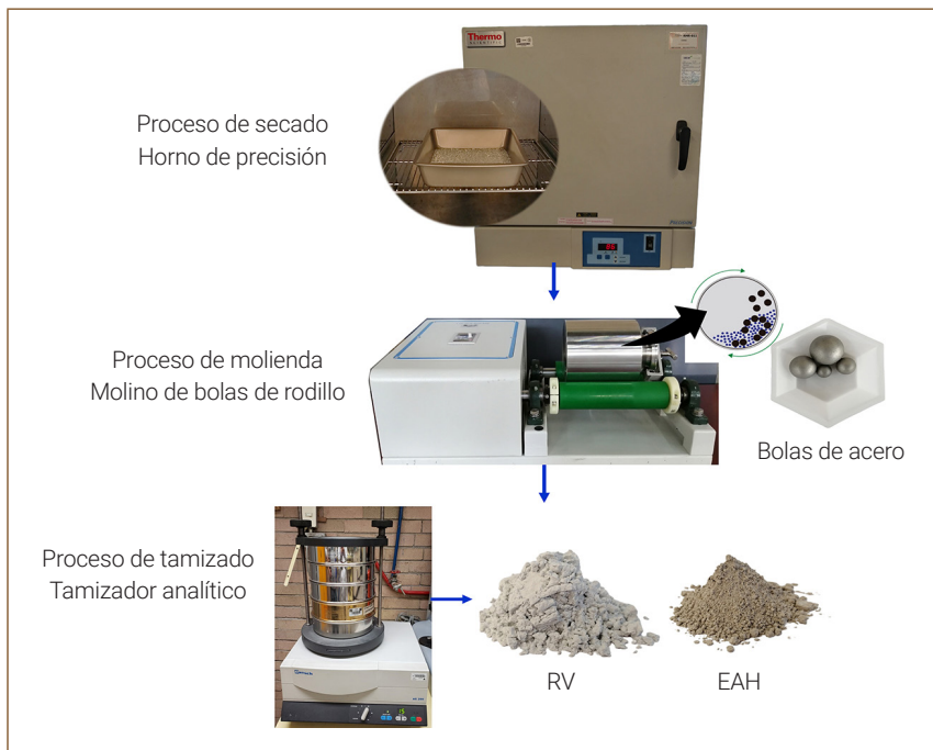
Figura 2. Proceso de acondicionamiento de los residuos.
