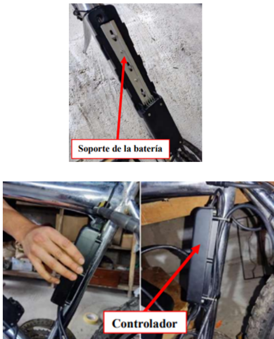
Figura 4. Colocación de soporte de batería y controlador
