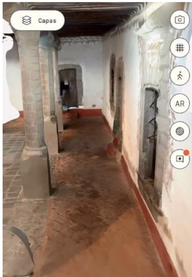
Figura 7. Levantamiento digital de la planta baja del claustro de la casa grande. Realización mediante PolyCam levantamiento LIDAR con Iphone 15. Elaboración propia 2025
