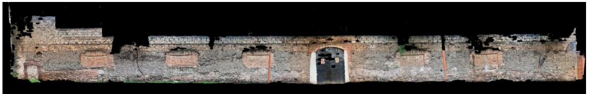
Figura 8. Ortomosaico de la fachada del molino, realizado mediante levantamiento digital. Toma de fotografías Iphone 15, procesamiento de información con AgiSoft MetaShape. Elaboración propia 2025
