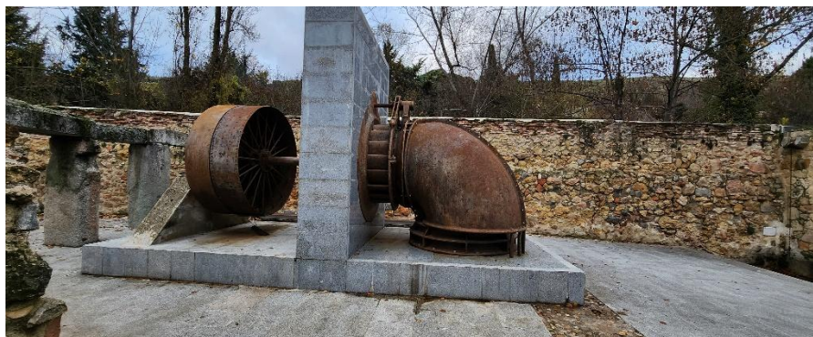
Figura 11. Turbina Francis en desuso, dispuesta con el eje horizontal y transmisión por polea. En exhibición en la Real Casa de Moneda en Segovia, España. Fuente: Héctor Edgar Perea Chairez, 2023
