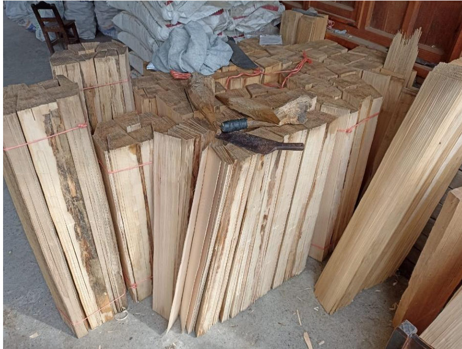
Figura 8. Erepitas y láminas de tejamanil ya trabajada. Archivo personal
