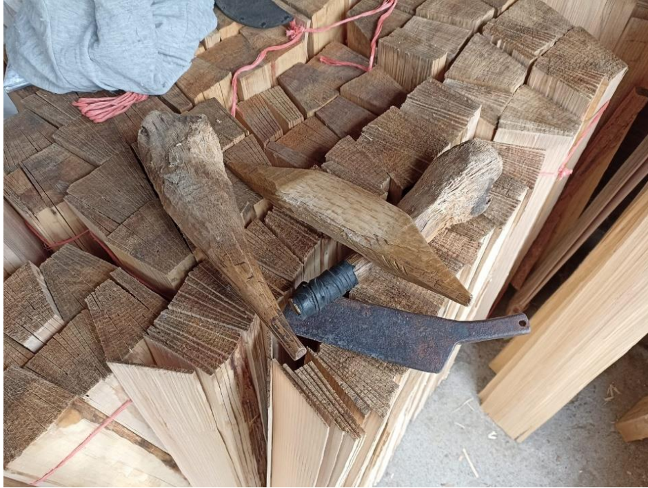
Figura 7. Herramientas utilizadas para la elaboración del tejamanil, sobre manos y láminas de material. Archivo personal
