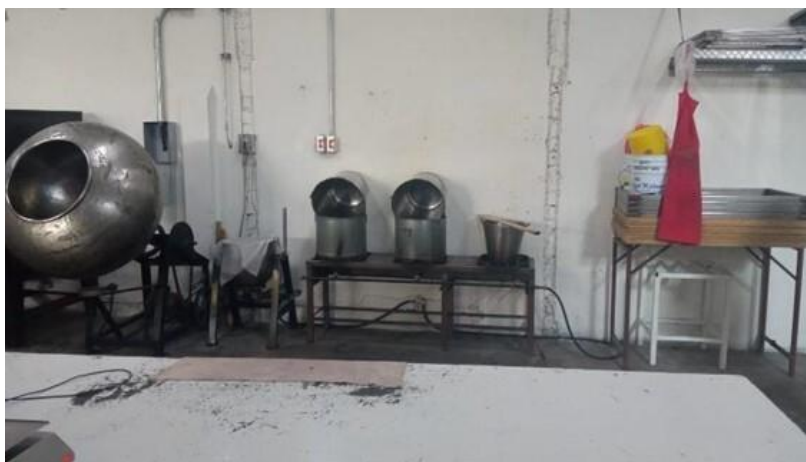
Figura 3. Bombo grageador (izquierda) utilizado en La Gabara para mezclar ingredientes en la producción de barras de amaranto
