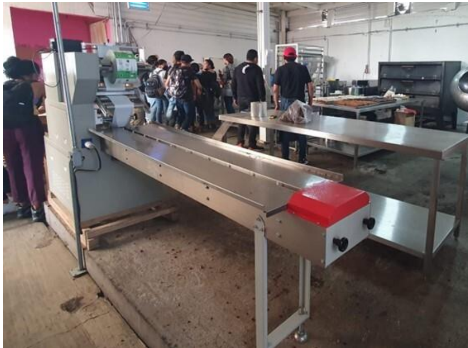
Figura 9. Máquina de empaquetado de las barras de amaranto en La Gabara
