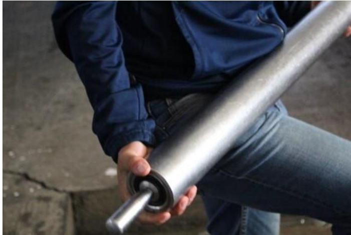
Figura 5. Rodillo metálico utilizado para compactar el amaranto y la mezcla de piloncillo y frutos
