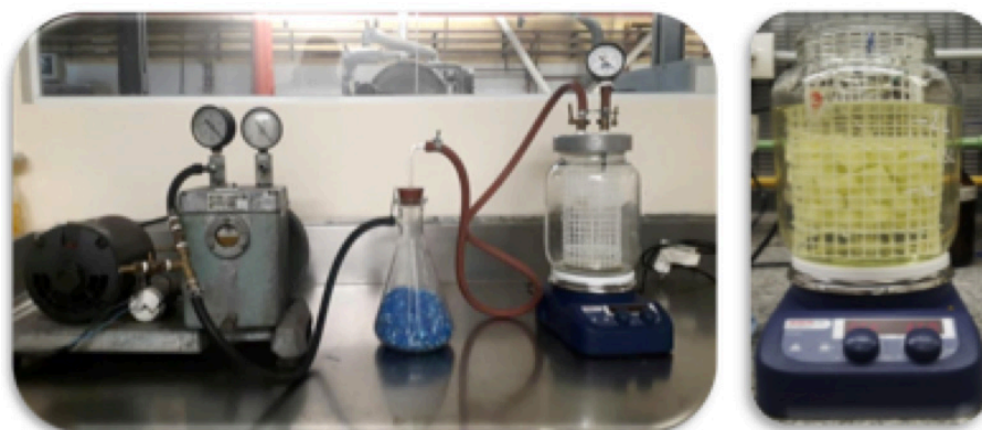
FIGURA 3 Equipo de impregnación por vacío para la obtención de manzanas mínimamente procesadas con alto contenido en vitamina C
