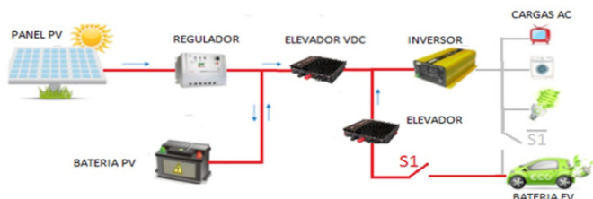
Figura 1. Topología micro red aislada
