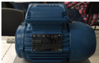
Figura 20. Motor de la máquina de fatiga
