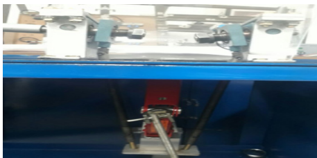
Figura 13. Barras de carga y funcionamiento de las articulaciones
