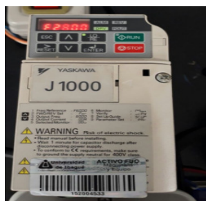
Figura 21. Variador de frecuencia de la maquina
