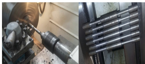
Figura 23. Proceso de construcción de la probeta de ensayo
