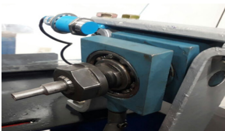
Figura 25. Sensor inductivo al no detectar la base del rodamiento.
