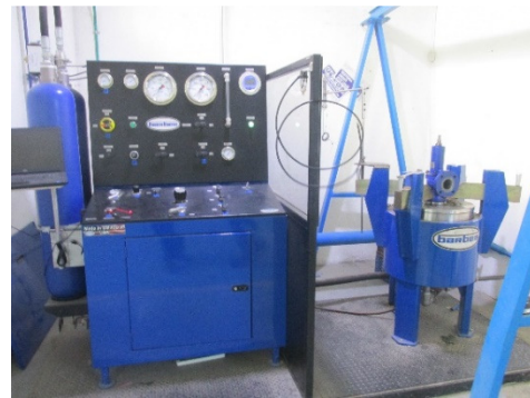
Fig. 3. Banco de prueba de válvulas con Nitrógeno
