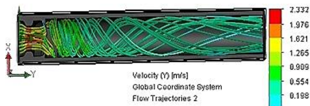
Fig. 8. Velocidad de los gases de combustión en el turbulador. Fuente. Elaboración propia.
