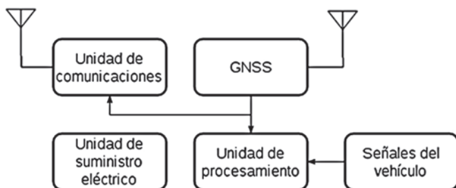
Figura 2. Diagrama de bloques de un dispositivo AVL básico
