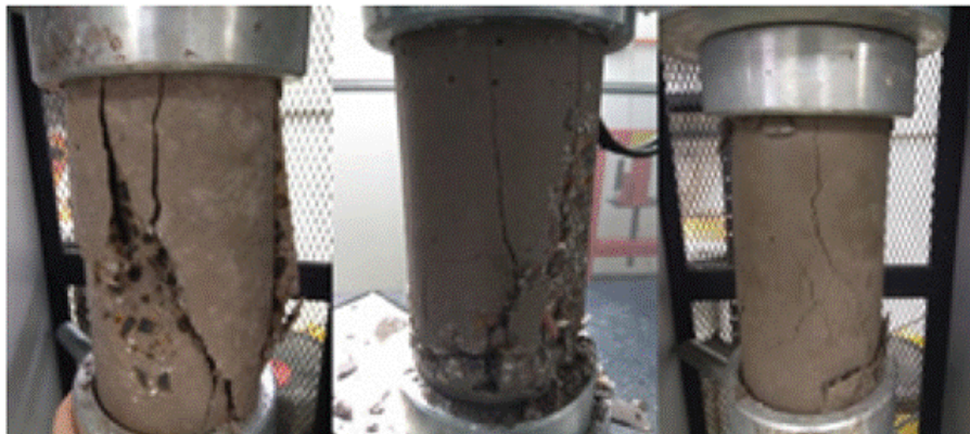
Figura 6 Tipos de falla concreto ligero Fuente: elaboración Propia.
