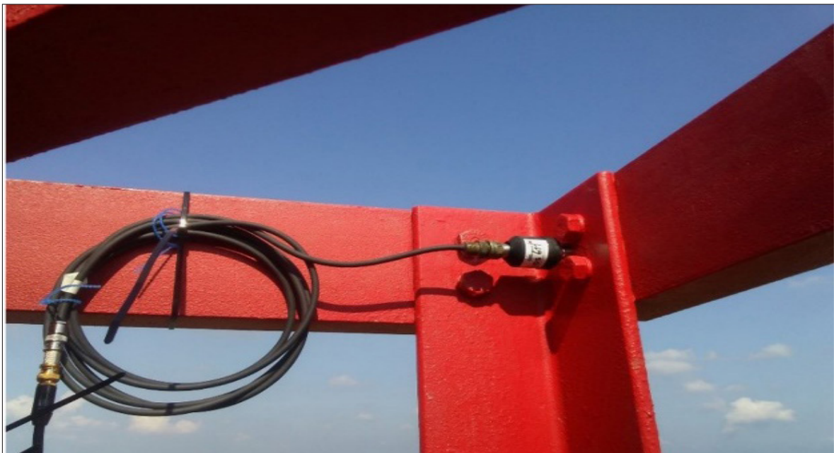
FIGURA 7. FIJACIÓN DEL ACELERÓMETRO 611 EN EL
