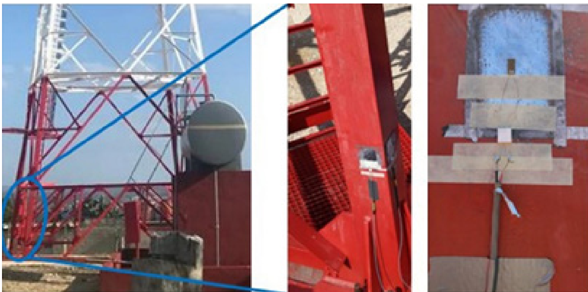
FIGURA 9. UBICACIÓN DE LOS STRAIN GAUGES EN LAS COLUMNAS
