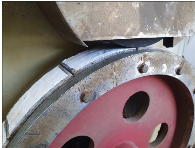
FIGURA 2. DETALLE DE APOYO DE RUEDA DE CAUCHO SOBRE LAS MUESTRAS
