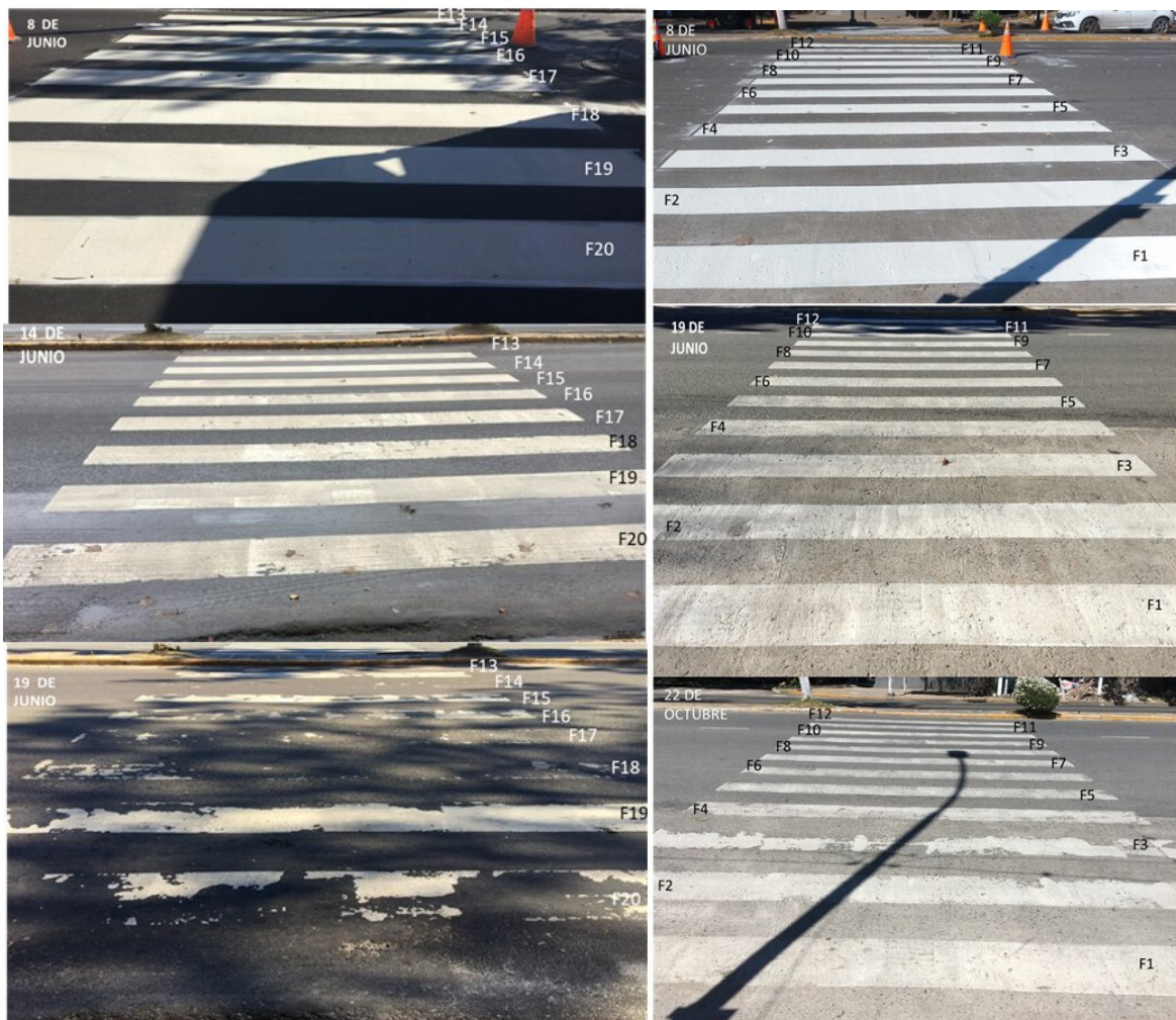
FIGURA 6. SECUENCIA DE FOTOS EN LA PRUEBA. IZQ.: PINTURA M3, DER.: PINTURA M4
