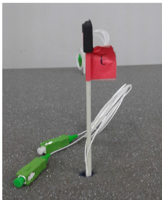
Figura 7. Inclinómetro fotónico implementado
