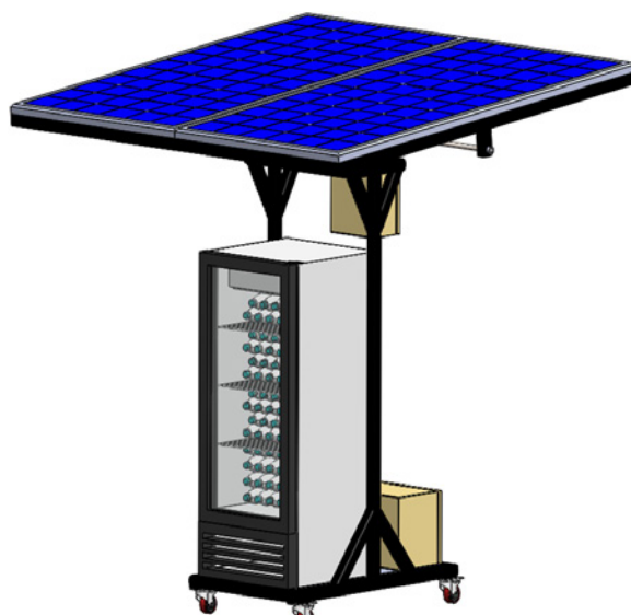
Figura 19. Modelo 3D y prototipo construido del refrigerador solar
