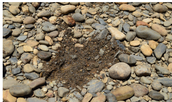
Figura 7. Verificación de campo del proceso de acorazamiento
