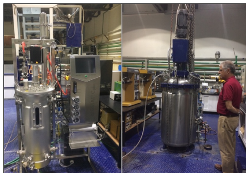
Imagen 2. Fermentadores de tanque agitado de 50 lts (izquierda) y 100 lts (derecha)
