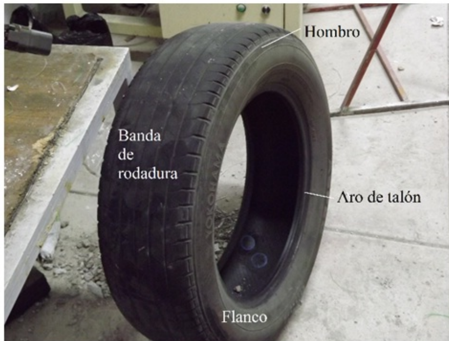
FIGURA 1. Partes principales de un neumático.
