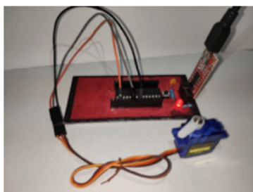
FIGURA 17. Configuración electrónica para controlar un servomotor.
