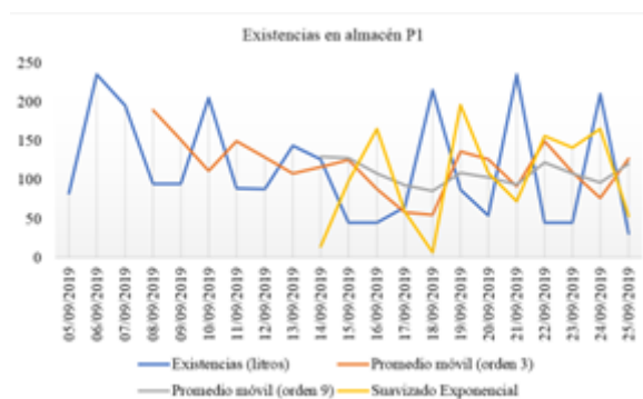
FIGURA 3. Gráfica con diferentes modelos de pronósticos del inventario de P1. Fuente: Elaboración propia.
