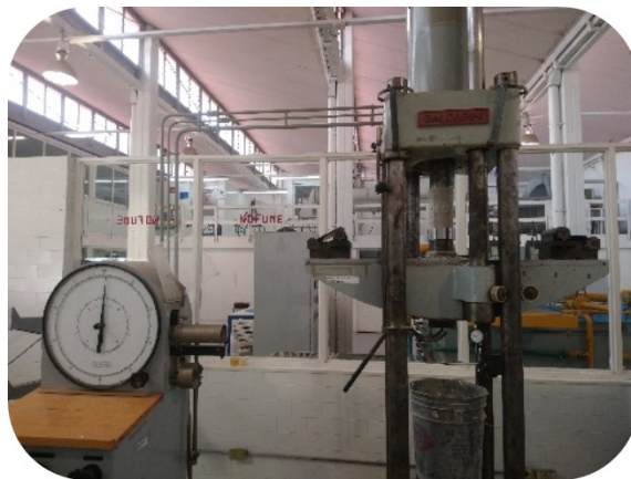
FIGURA 2.- Maquina universal, utilizada durante el ensayo de compresión.
