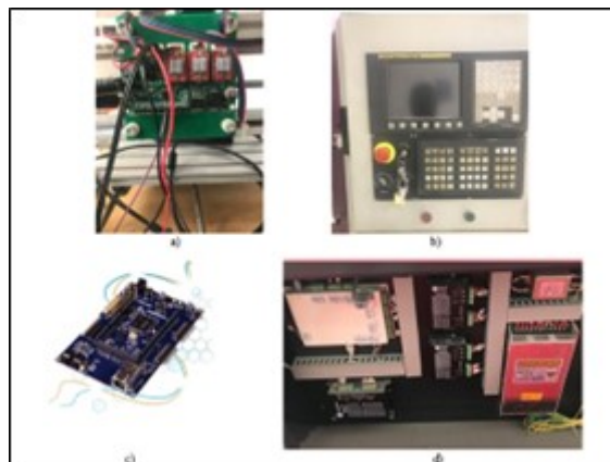
FIGURA 2 Placas de control analizadas a) CNC 3018, b) CMV XH714, c) Impresora Rise3D y Plotter de corte, d) Láser CO2.
