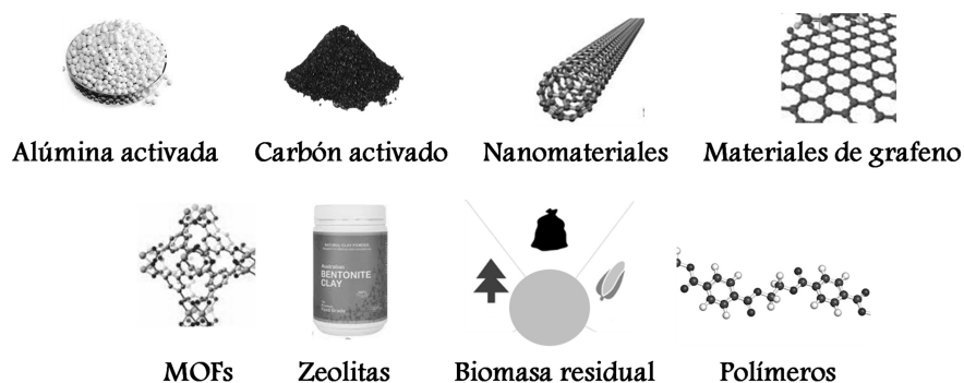
FIGURA 2 Ejemplos de adsorbentes utilizados en el tratamiento y purificación de agua. Elaboración propia.
